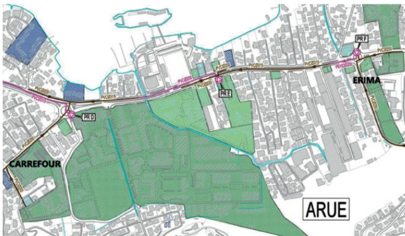
Sur les 12 kilomètres de réseau, 2,5 concernent Arue. En rose, le réseau sous pression, en marron le réseau gravitaire et en PR, les trois postes de refolement et de relevage.
